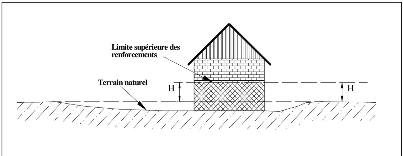
En cas de terrassements en déblai, la hauteur doit être mesurée par rapport au terrain naturel initial.
